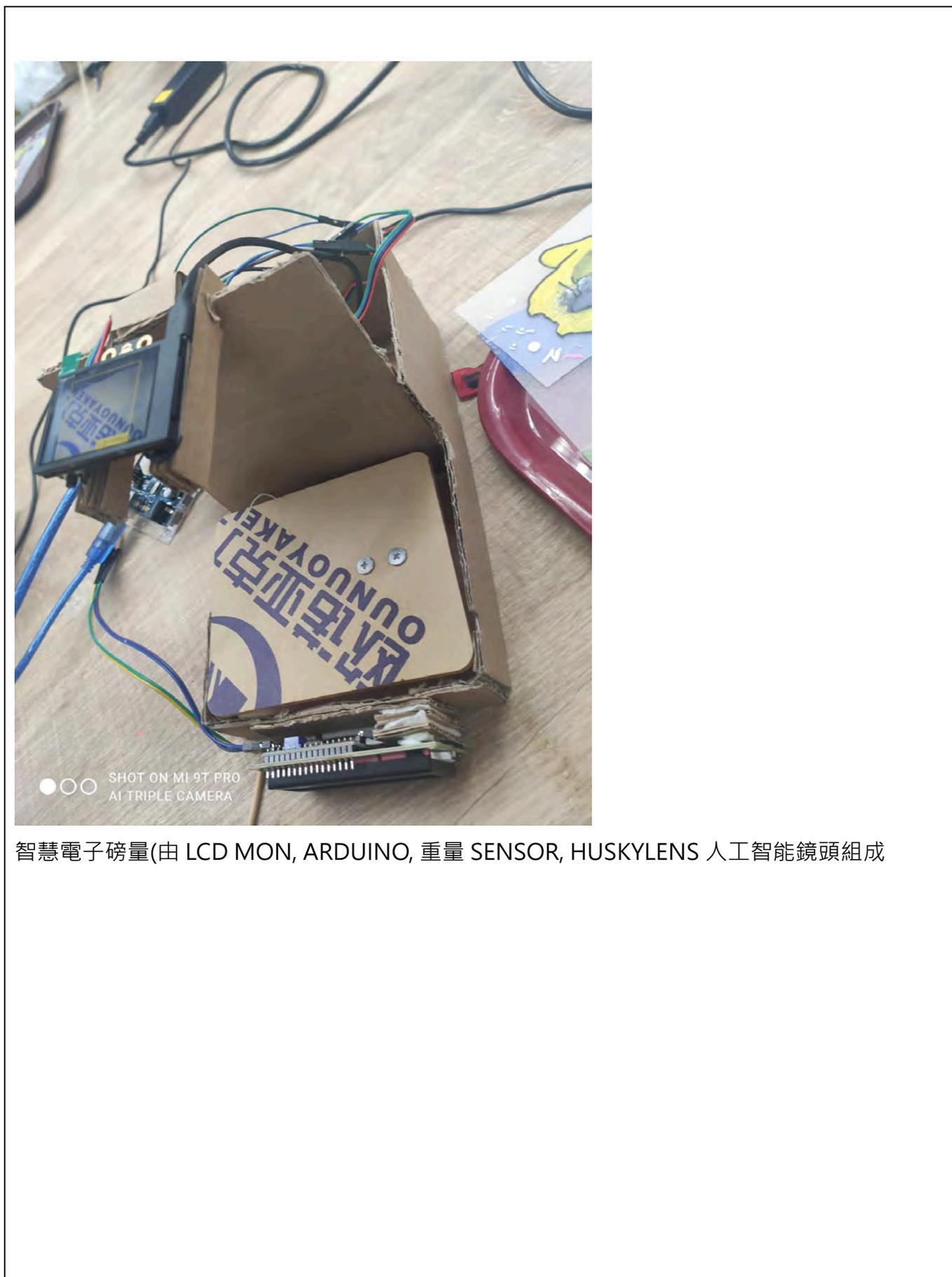
智慧電子磅量(由 LCD MON, ARDUINO, 重量 SENSOR, HUSKYLENS 人工智能鏡頭組成)
