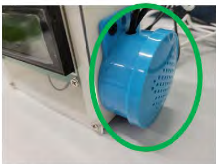
揚聲器：小童走進廚房時會即時以語音的方式，讓小童得知不能走進廚房，並要求讓小童離開廚房。
